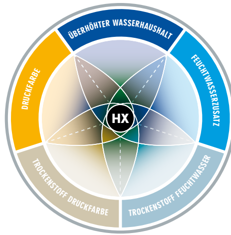
Abbildung 2: Der Oxi-graph zeigt die Interaktion von fünf schwer zu steuernden Einflussfaktoren, die chemische Angriffe auf den Walzenbezug verursachen können. Der Spezialwerkstoff Werograph-HX kann hier Abhilfe schaffen.
