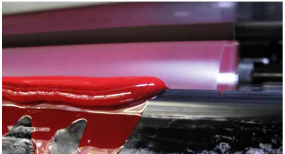
Mit Raizair-Blade kann die Farbwulst auf der Rakellippe deutlich schneller und effizienter entfernt werden
