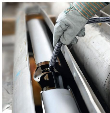
Die Walzenbeschichtung muss abriebbeständig sein, ableitend, ozon- und temperaturbeständig, leitfähig...
