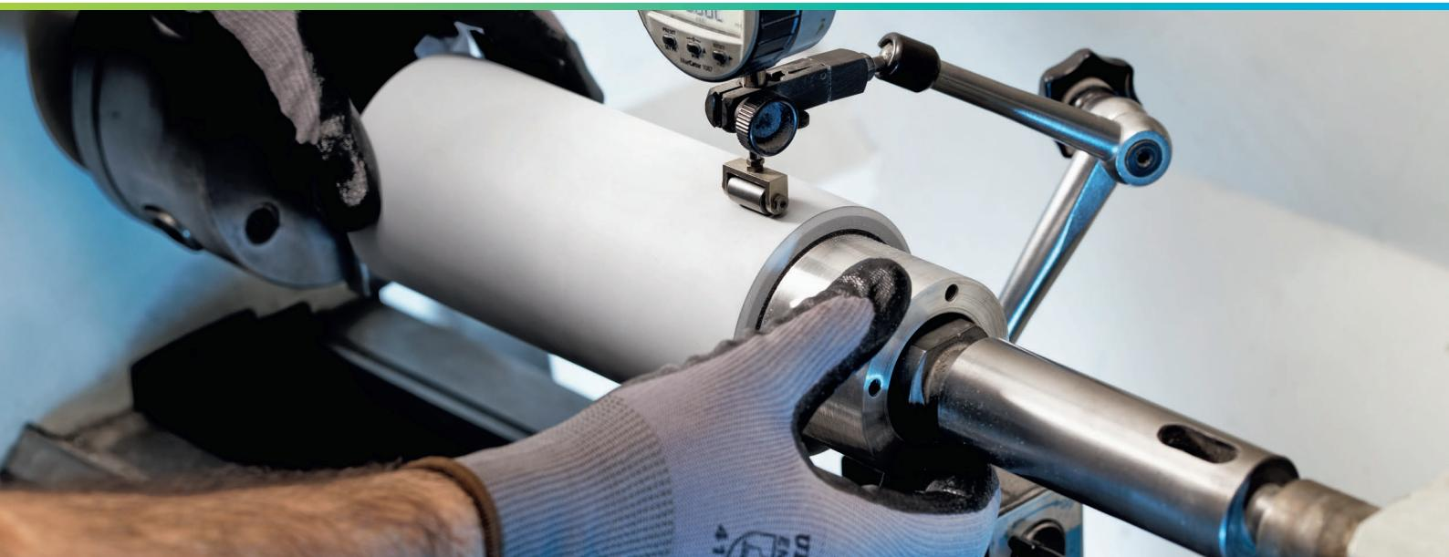
Kontroll- und Prüfinstanzen sind in der Walzenproduktion unabdingbar. Westland vertraut auf sensorgesteuerte Lasermesstechnik. Und auf das Fingerspitzengefühl seiner Leute.
