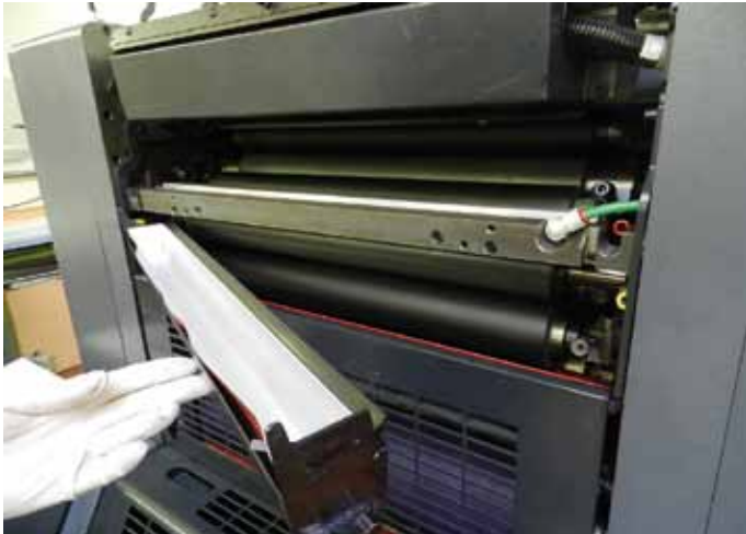
Das Razair-Blade-System ist für alle Druckmaschinen mit stehendem oder stechemdem Rakel geeignet
